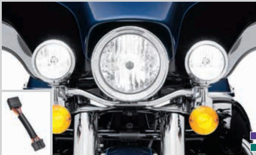
E. ZUSATZSCHEINWERFER-KABELBAUM ZUR UNABHÄNGIGEN STEUERUNG (TOURING ABGEBILDET)
