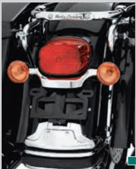
H. BULLET BLINKERSTANGE HINTEN UND NUMMERSCHILDVERLEGUNGS-KIT
