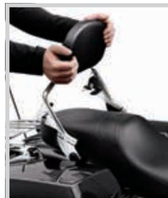
Mit einem Montagekit montieren und demontieren Sie abnehmbares Zubehör mit ein, zwei einfachen Handgriffen. Drehen Sie die Haltenocken, um die Sissy Bar von den hinteren Befestigungspunkten zu lösen. Drehen Sie die Sissy Bar nach vorne und heben Sie sie dann an den vorderen Befestigungspunkten an.
