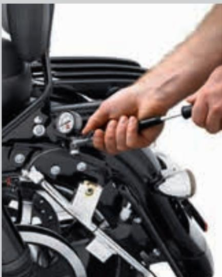
C. ANALOGE TOURING LUFTPUMPE FÜR FEDERUNG
