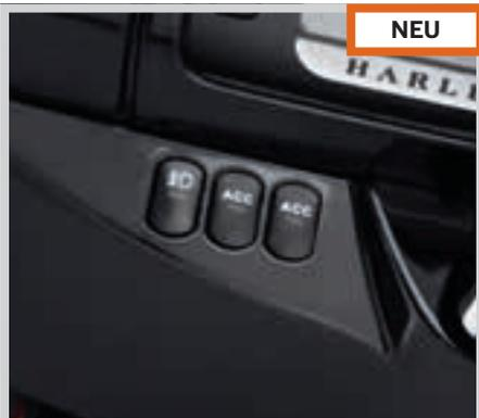
G. ZUSÄTZLICHER STROMSCHALTER – VERKLEIDUNGSMONTIERT (71400106 ABGEBILDET)
