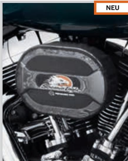
B. VENTILATOR ELITE LUFTFILTER-KIT (ABGEBILDET MIT REGENSCHUTZ)
