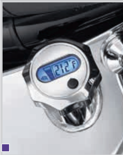
A. PEILSTAB FÜR ÖLSTAND UND ÖLTEMPERATUR MIT BELEUCHTETER LCD-ANZEIGE – CHROM (SOFTAIL ABGEBILDET)
