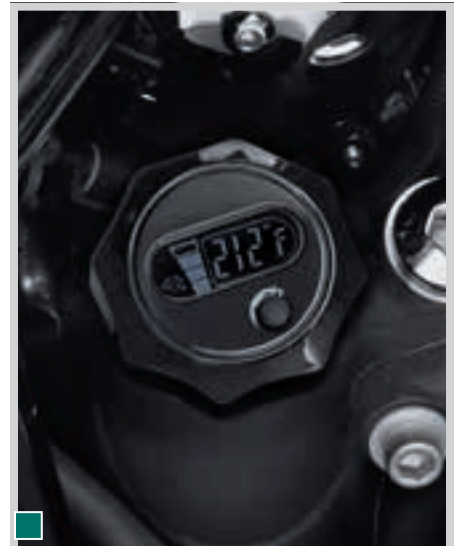
A. PEILSTAB FÜR ÖLSTAND UND ÖLTEMPERATUR MIT BELEUCHTETER LCD-ANZEIGE – SCHWARZGLÄNZEND (TOURING ABGEBILDET)
