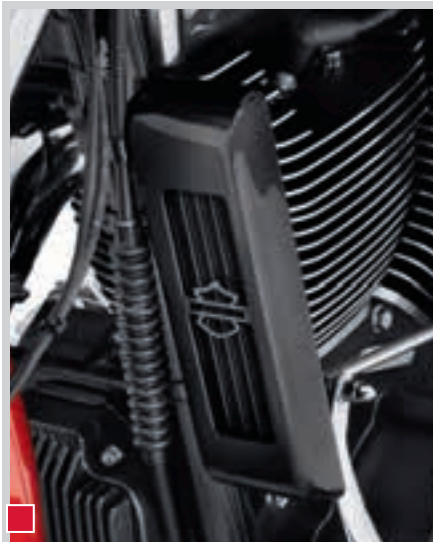
A. PREMIUM ÖLKÜHLER-KIT – DYNA SEITLICH MONTIERT
