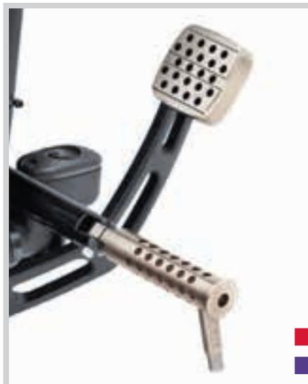
G. SILENCER BREMSPEDALAUFLEGE (ABGEBILDET MIT SILENCER FUSSRASTE MIT ABGESTIMMTEM ERSATZVERSCHLEISSSTÜCK)
