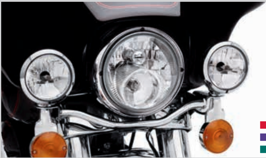
Doppelbirnen-Halogen-Scheinwerfer Fernlicht (7") Vogelperspektive (in Fuß abgebildet)
