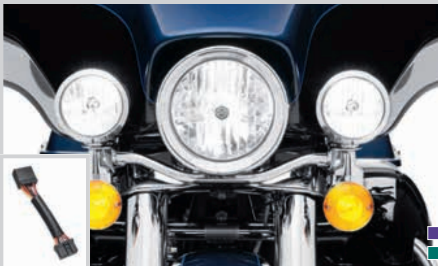
E. ZUSATZSCHEINWERFER-KABELBAUM ZUR UNABHÄNGIGEN STEUERUNG (TOURING ABGEBILDET)
