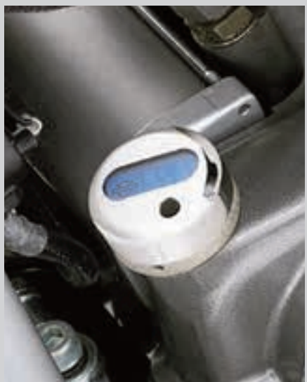
J. ÖLTEMPERATUR-MESSSTAB MIT BELEUCHTETER LCD-ANZEIGE
