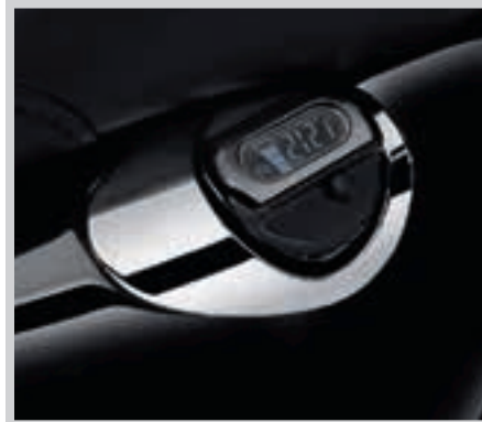
J. PEILSTAB FÜR ÖLSTAND UND ÖLTEMPERATUR MIT BELEUCHTETER LCD-ANZEIGE – SCHWARZGLÄNZEND
