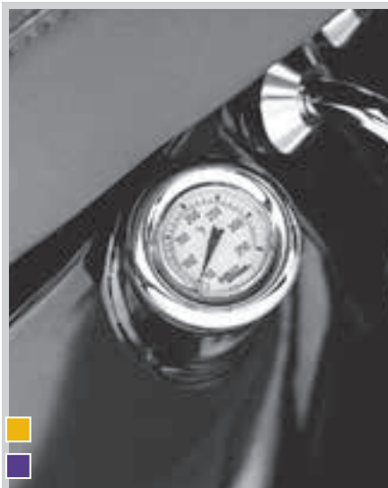
B. ÖLPEILSTAB MIT TEMPERATURANZEIGE (SOFTAIL ABGEBILDET)
