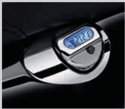
J. PEILSTAB FÜR ÖLSTAND UND ÖLTEMPERATUR MIT BELEUCHTETER LCD-ANZEIGE – CHROM
