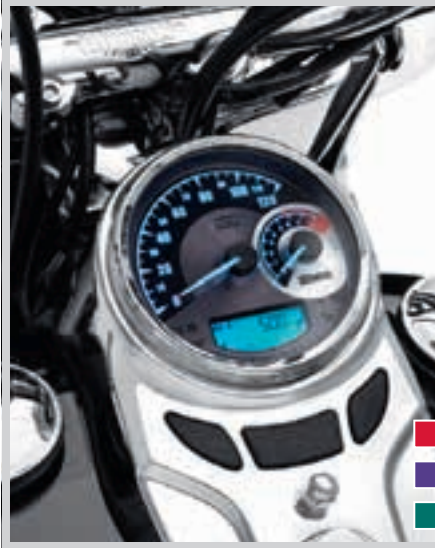
A. KOMBINIERTER ANALOGER TACHOMETER/DREHZAHLMESSER – 5" ALUMINIUMGUSS-ZIFFERBLATT
