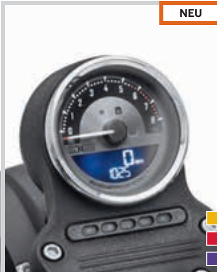
B. DIGITALER TACHOMETER/ANALOGER DREHZAHLMESSER – 4" ALUMINIUMGUSS-ZIFFERBLATT
